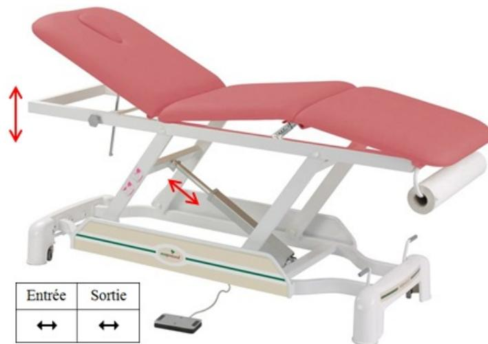
En entrée du système, le piston du vérin a un mouvement de translation par rapport au corps du vérin (le corps du vérin est en rotation par rapport au bâti de la table). En sortie du système, la table de massage est en translation circulaire par rapport au bâti de la table.
