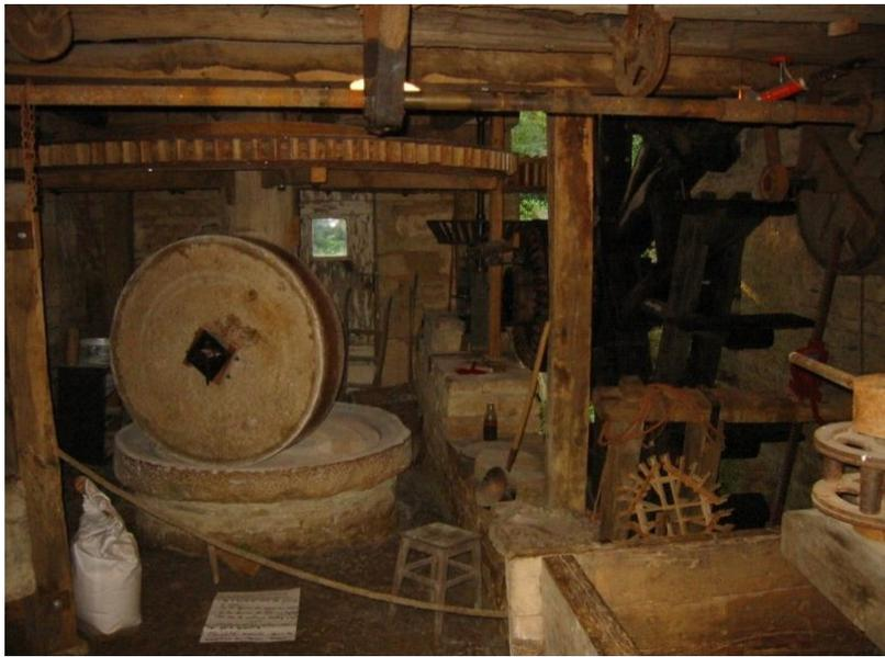
Dans ce moulin à eau un ensemble de roues dentées permet de transmettre le mouvement de la roue (mue par l'eau) à la meule.
