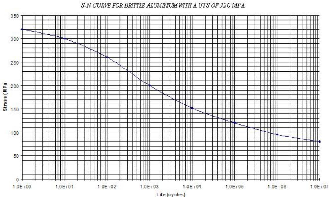
FIGURE 1 – Courbe de Wöhler d'un alliage d'aluminium
