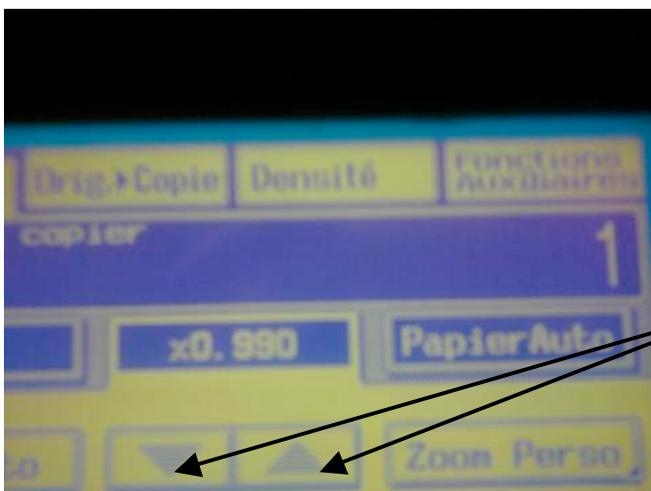
En appuyant sur les flèches, on diminue ou on augmente le coefficient par lequel la largeur et la longueur de la page sont multipliées.
