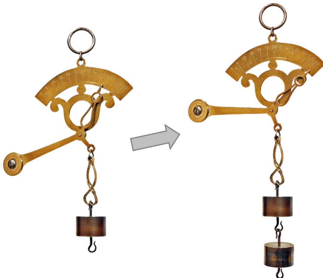
Pèse-lettre gradué de 0 à 100 g Hauteur totale au repos : 15 cm Fabriqué par Narcisse Briais
