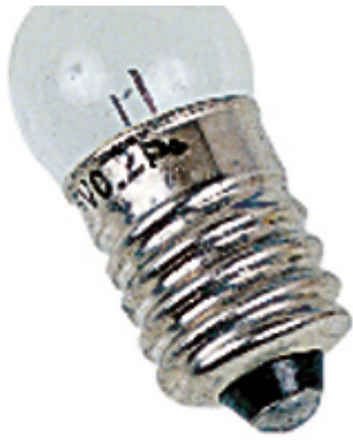
Ampoule à vis, tension 3,5 V, intensité 0,2 A, culot E 10
